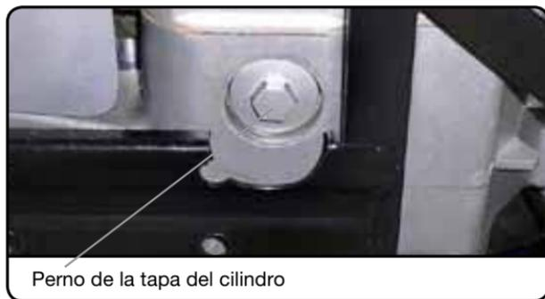
b. Afloje ligeramente el perno de la tapa de cilindro.
