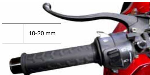
palanca en el rango de movimiento libre deseado. En caso de requerir un ajuste de mayor grado, gire el embrague ajustando el tornillo sobre el cárter derecho del motor. Si se presentan dificultades para realizar los cambios, o el embrague patina, debe realizarse un reajuste.
