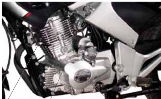
Tapa de válvula Tornillo visor superior Tornillo visor central
